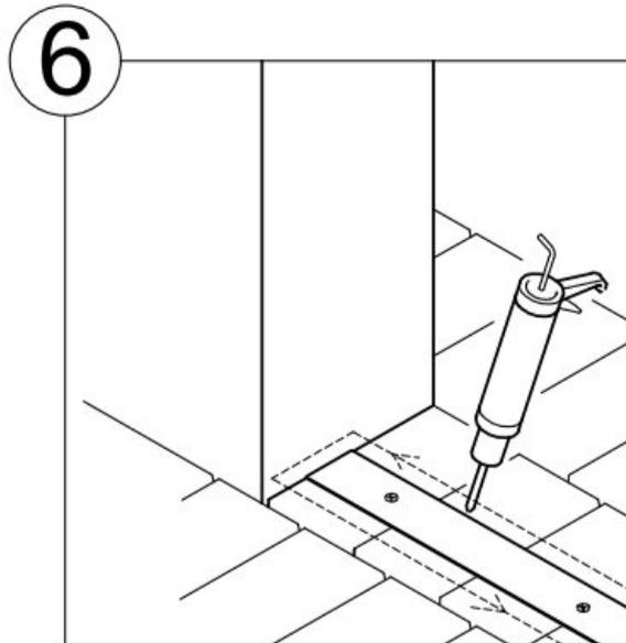
Posizionare i supporti laterali sopra il profilo soglia (se installato) e nel punto desiderato, in modo che siano paralleli e sullo stesso piano. Segnare i fori, forare e pulire bene la superficie. Stendere del silicone sotto i supporti laterali quindi fissarli alla parete con le viti. Completare la sigillatura lungo i supporti laterali.
