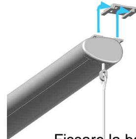
Fissare le staffe in bolla per il corretto funzionamento della tenda
