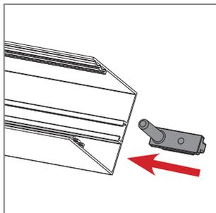
**1** Inserire la baionetta superiore nella scanalatura della guida superiore. (NB il lato di inserimento della baionetta resterà fisso, per cui la zanzariera si aprirà dal lato opposto.)
