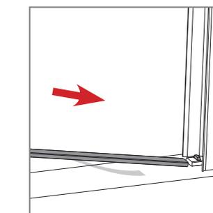
**10** Prendere la guida inferiore, rimuovere la pellicola protettiva del nastro biadesivo ed applicarla a pavimento tra i due profili laterali, ottenendo come risultato la vignetta in alto.
