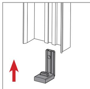
**6** Prendere il profilo laterale ed inserire dal basso la baionetta inferiore nella scanalatura. **ATTENZIONE!** La baionetta inferiore e superiore devono trovarsi sullo stesso lato!
