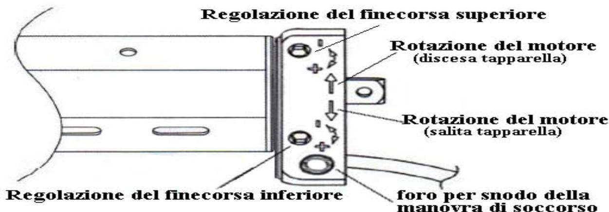
**! Indipendentemente dal lato del rullo in cui viene montato il motore (a destra oppure a sinistra), per regolare l'apertura della tenda occorre agire sempre sul finecorsa che presenta la freccia verticale di Rotazione diretta in basso.**
