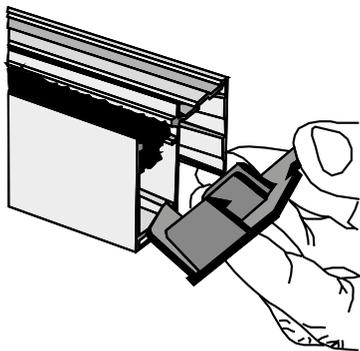
6. Fissare, con le viti in dotazione, i fermi per le guide sul telaio.
