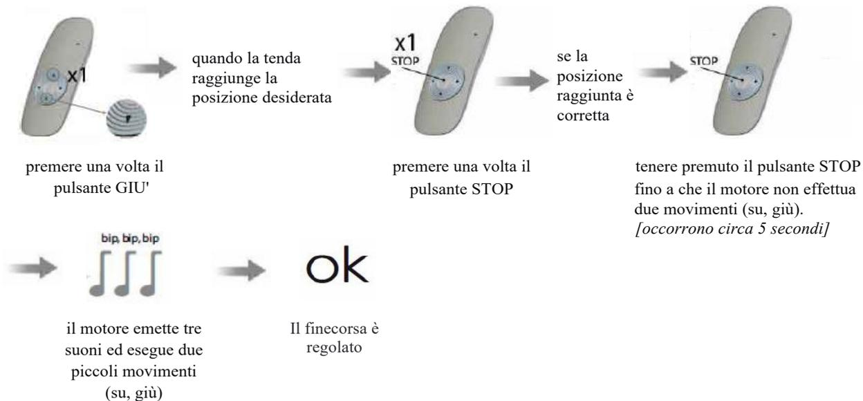
**Nota.** Se la posizione raggiunta dalla tenda non è quella desiderata, prima di tenere premuto il tasto "STOP" per memorizzare la posizione del finecorsa inferiore, dare nuovamente il comando al motore per fare scendere ulteriormente la tenda. Non appena viene raggiunta la posizione desiderata, tenere premuto il pulsante "STOP" fino a che il motore non effettua due movimenti (su, giù).
