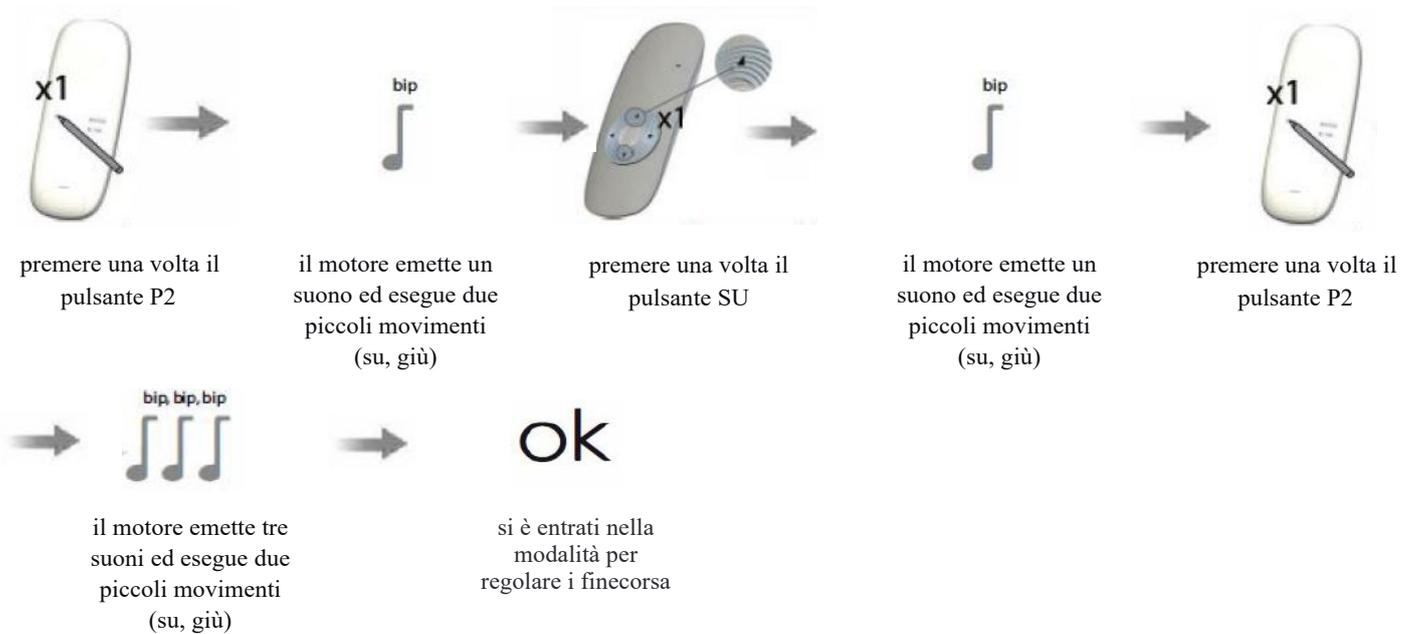
**Passo 2 - Registrazione del finecorsa superiore del motore**
