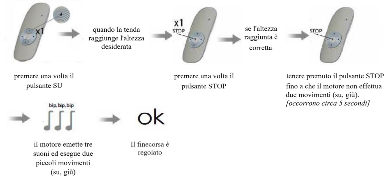
**Nota.** Se la posizione raggiunta dalla tenda non è quella desiderata, prima di tenere premuto il tasto "STOP" per memorizzare la posizione del finecorsa superiore, dare nuovamente il comando al motore per fare salire ulteriormente la tenda. Non appena viene raggiunta la posizione desiderata, tenere premuto il pulsante "STOP" fino a che il motore non effettua due movimenti (su, giù).
