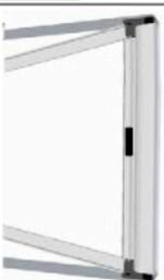
Ruotare le guide, superiori e inferiori, fino al loro congiungimento e fissare, con le viti in dotazione, i fermi.
