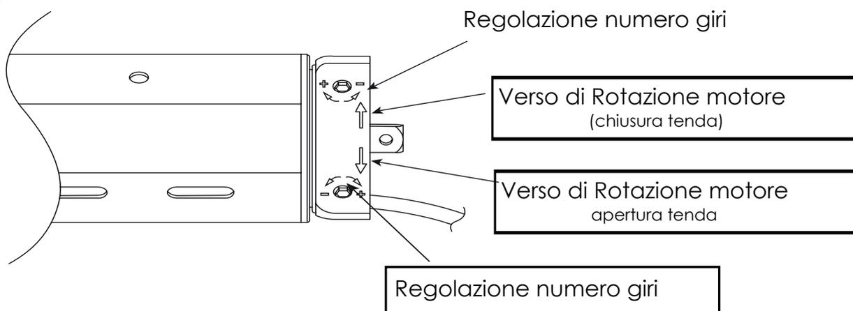
! Indipendentemente dal lato del rullo in cui viene montato il motore (a destra oppure a sinistra), per regolare l'apertura della tenda occorre agire sempre sul finecorsa che presenta la **freccia verticale di Rotazione diretta in basso**.
