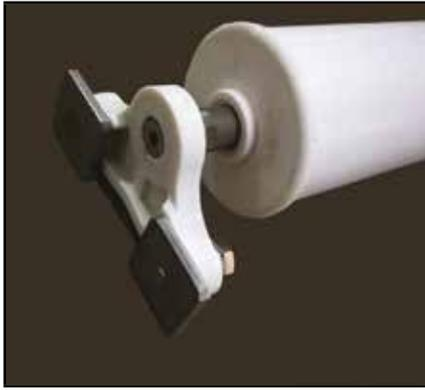
Montare se presenti i frangivento (C) avendo cura di aprire i tappi (12) con una chiave a brugola da 6 prima di inserirli nel profilo (A) e successivamente rimontarli e serrarli (in posizione mediana rispetto al muro e la curva)
