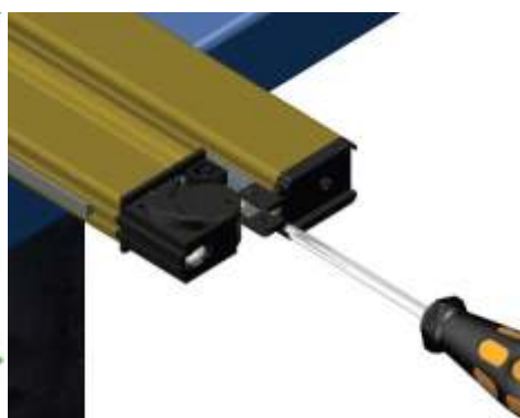
Fissare la testata con le viti ts 2,9x19
