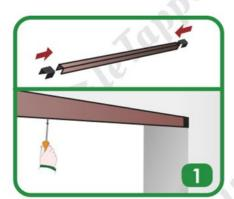
Posizionare alle due estremità della guida superiore le 2 cuffie. Quindi fissare la guida superiore al soffitto con le viti.
