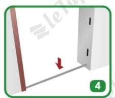
Togliere il biadesivo dal binario e fissarlo a terra in linea con quanto già montato.
