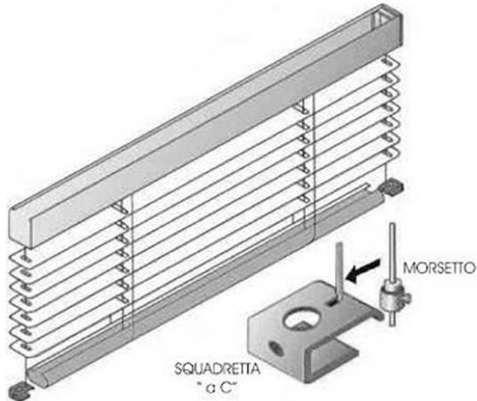
Al fine di evitare problemi di discesa della veneziana, fate attenzione che il cavetto della guidatura sia perpendicolare al foro del cassetto e ai fori delle lamelle.
