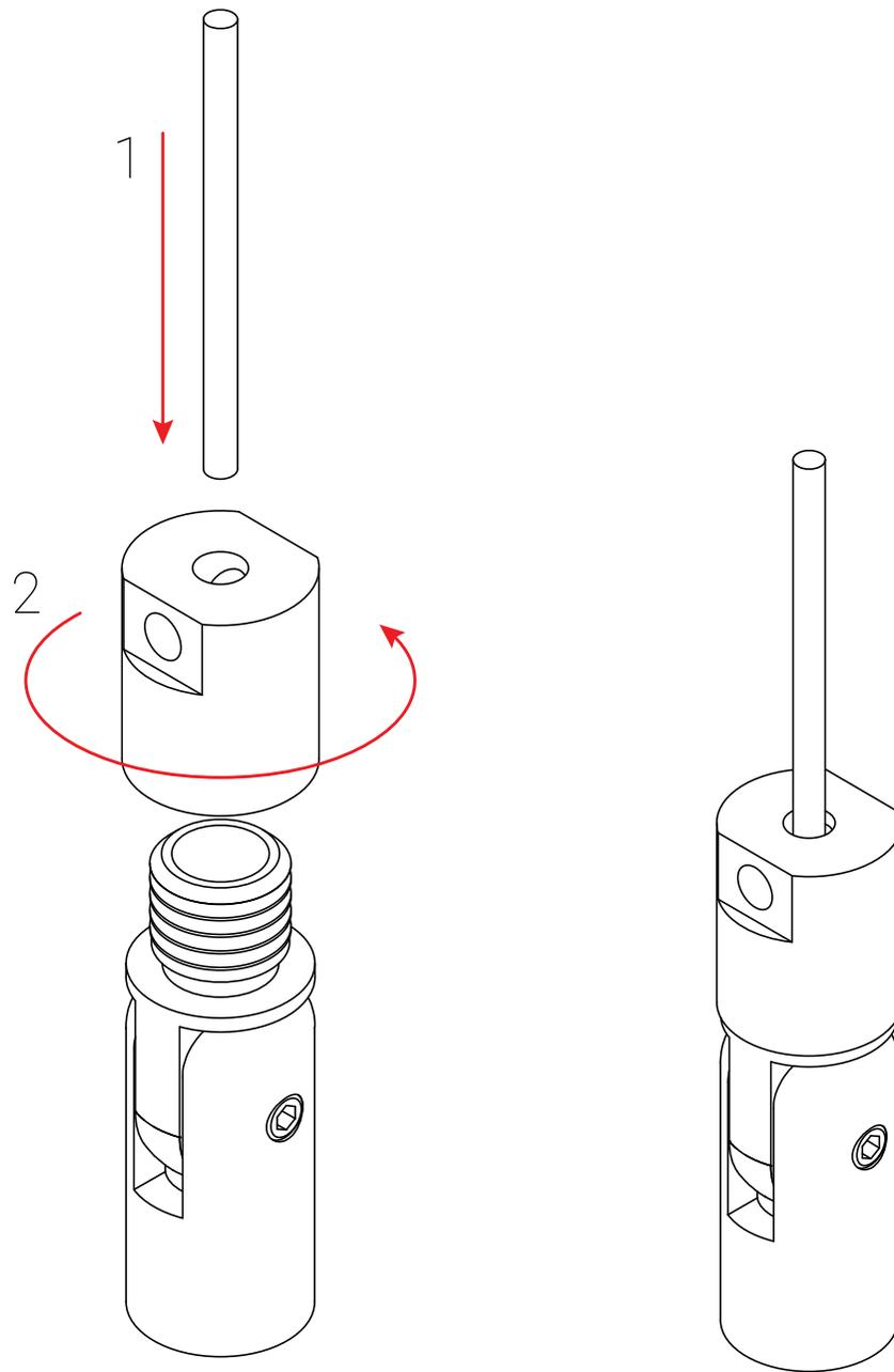
AVVITARE I GRANI M6 L 8mm NEI FORI EVIDENZIATI IN FIGURA PER TENERE IN TENSIONE IL CAVO
