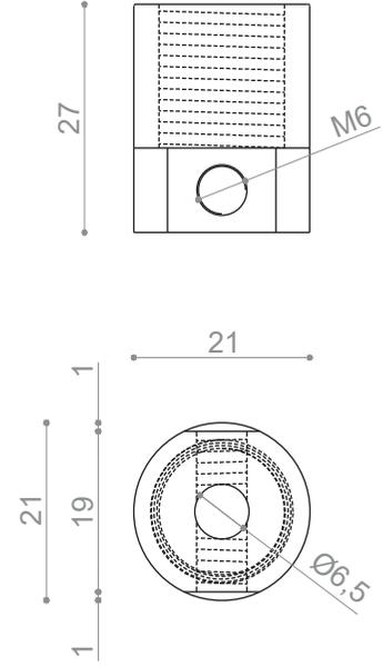
PER FISSARE IL PIEDE A PAVIMENTO O A MURO INSERIRE IL TASSELLO ALL'INTERNO DEL FORO.
