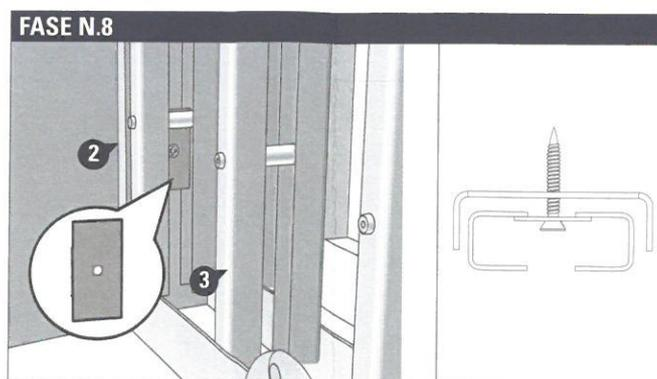
Fissare telo (3) e frontalino di raccolta (2) insieme utilizzando i lamierini con occhio in dotazione, posizionandoli tra i primi due profili a "U" del telo (3) ed in corrispondenza del foro posto nel frontalino. Dopo la posa in opera, verificare l'apertura e la chiusura del cancelletto, il funzionamento della serratura e delle guide ribaltabili.
