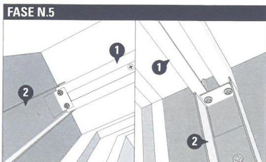
Inseriti i frontalini (2), procedere con il fissaggio della guida superiore (1) ai frontalini laterali (2) usando le viti autoforanti in dotazione, inoltre è possibile fissare la guida superiore con opportuni tasselli antieffrazione (dim. 8x60mm, non forniti) a discrezione del cliente;
