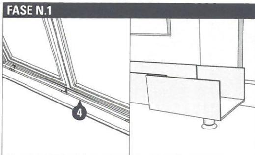
Posizionare le guide inferiori (4) e fissarle con opportuni tasselli antieffrazione (dim. 8x60mm, non forniti; oltre ai fori per il fissaggio delle guide, ricordarsi di praticare il foro per il nottolino in posizione centrale);
