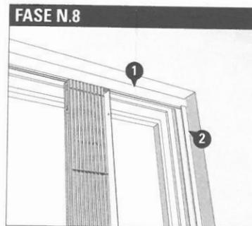
Successivamente appoggiare la guida superiore (1) sul frontalino di chiusura (2) sullo stesso alloggiamento.
