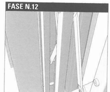
Fissare definitivamente il tutto con opportuni tasselli anti-effrazione (dim. 8x60mm, non forniti). Dopo la posa in opera, verificare l'apertura e la chiusura del cancelletto, il funzionamento della serratura e della guida ribaltabile.
