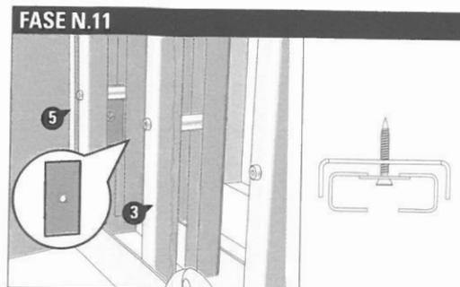
Fissare insieme il telo (3) e il frontalino di raccolta (5) utilizzando i lamierini con occhio in dotazione, posizionandoli tra i primi due profili a "U" del telo (3) e in corrispondenza del foro posto nel frontalino.
