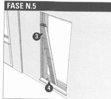
Inserire il telo (3) nella guida inferiore (4) e tenere inclinato verso di sé.
