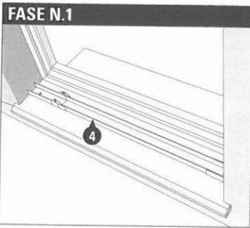
Posizionare la guida inferiore (4) e fissarla con opportuni tasselli anti-effrazione (dim. 8x60mm, non forniti).
