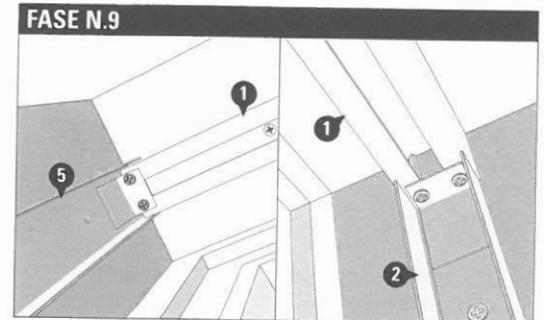
Adagiare il tutto nel vano e fissare la guida superiore (1) ai frontalini laterali (2)(5) usando le viti autoforanti in dotazione, inoltre è possibile fissare la guida superiore con opportuni tasselli anti-effrazione (dim. 8x60 mm, non forniti) (a discrezione del cliente).
